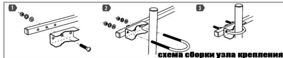
схема сборки узла крепления
