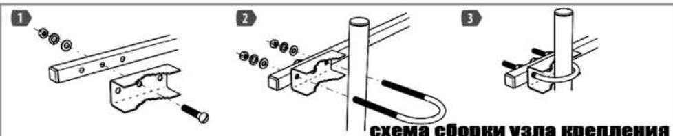
схема сборки узла крепления
